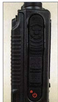
Hinter zwei Gummiabdeckungen verbergen sich Anschlussbuchsen und ein Steckplatz für eine Speicherkarte.
