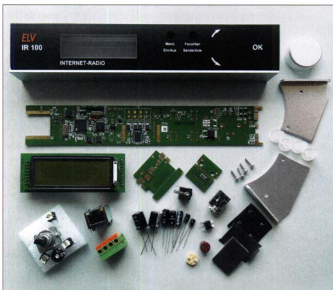
Bild 1: Der Bausatz des Internetradios IR100 besteht aus relativ wenigen, weitestgehend vorgefertigten Einzelteilen. Ein interner Lautsprecher ist aufgrund der geringen Gehäuseabmessungen nicht vorgesehen.
