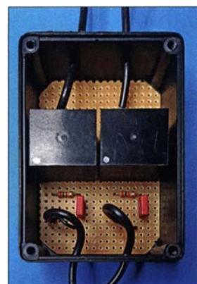
Bild 7: Die wenigen für das NF-Interface erforderlichen Bauelemente lassen sich auf einer Universalplatine montieren. Hier kamen als NF-Übertrager zwei noch in der Bastelkiste vorhandene SV1-500A zum Einsatz.
