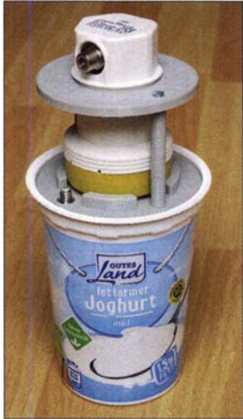
Bild 7: Montierter Dualband-Erreger mit Joghurtbecher als Schutzkappe
