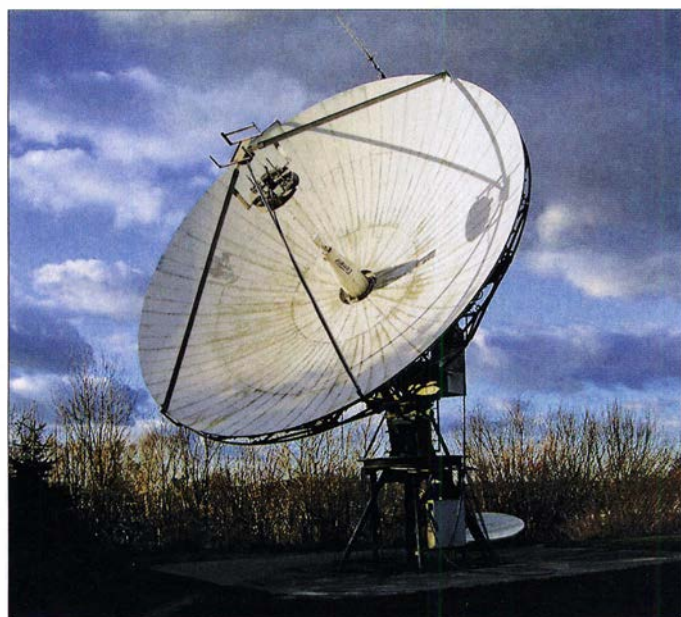
Bild 1: 9-m-Parabolspiegel für radioastronomische Messungen an DLOSHF in der Nähe von Kiel [1]
