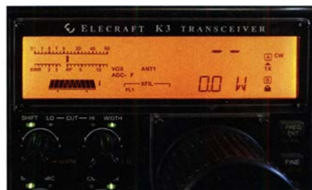
Nichts geht mehr: einer unserer K3 ohne Ausgangsleistung
