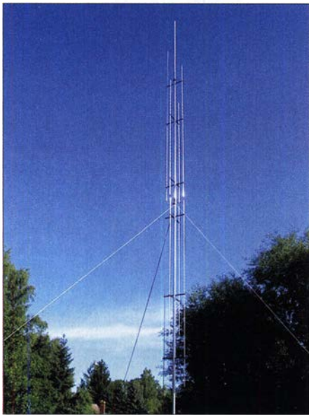
Bild 1: Fünfband-Vertikaldipol nach SM6DOI, beschrieben in [1], als praktisches Beispiel zur Simulation gemäß Bild 2
