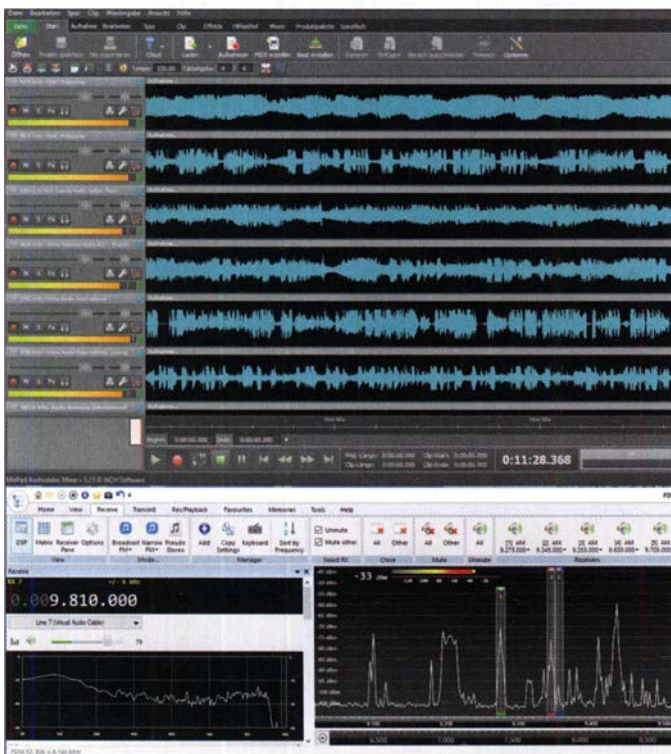
Bild 23: Die Software MixPad (oben) nimmt beliebig viele Spuren von unterschiedlichen Quellen auf. Hier von sieben Demodulatoren (RX1 bis RX7, unten) im 31-m-Rundfunkband, die über VAC1 bis VAC7 weitergeleitet werden. Screenshots: DK8OK
