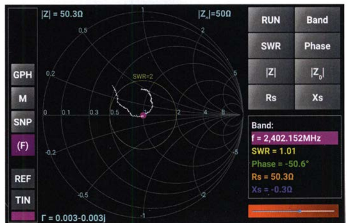
Bild 9: Verlauf von Reflexionsdämpfung und SWV der Helix-Antenne mit 3\frac{1}{4} Windungen im Frequenzbereich 2,2 GHz bis 2,5 GHz
