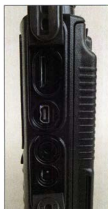
Hinter zwei Gummiabdeckungen verbergen sich Anschlussbuchsen und ein Steckplatz für eine Speicherkarte.
