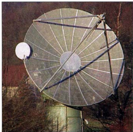
Bild 14: Ein 80-cm-Spiegel für 11 GHz (Satelliten-Fernsempfangsanlage) ist an einem 5-m-Parabolspiegel montiert. Damit kann dessen Positioniereinrichtung für die Messung des Mondes genutzt werden [5].
